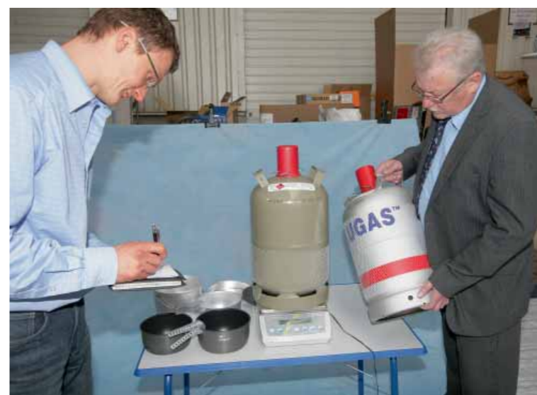
Leichtmetall, Teil 1: Mit zwei gefüllten 11-kg-Alu-Gasflaschen spart man reell 9,35 Kilogramm gegenüber den konventionellen Varianten aus Stahl.
